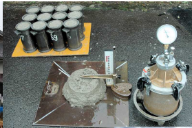
生コン車が来ると必ずサンプルを取り検査、安心です。
