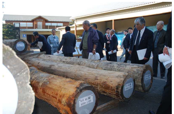
二階の大屋根を支える地棟は米松、設計強度の太さは貼ってある白い紙の直径で、使用材は1.5倍以上の太さがあります。
